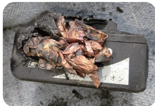
電動工具用非純正電池での発熱事例
