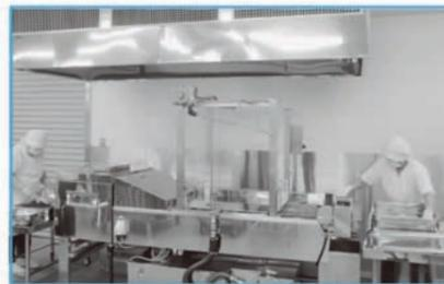
最新機器を利用した効率的な調理を行います。(写真は連続式大型フライヤー)
